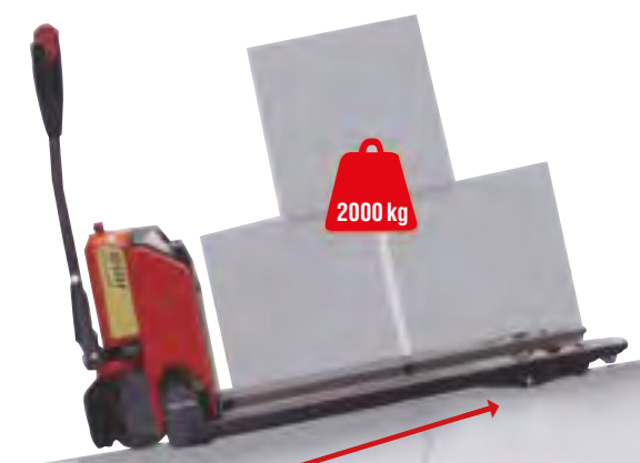
Pendenza massima carico 7% scarico 16%
